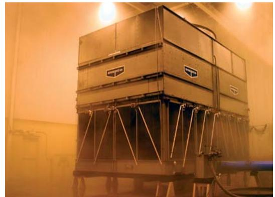
El Centro de Investigación incorpora Cámaras de Pruebas Térmicas para ensayos a escala real, de acuerdo con las reglas del arte, de equipos de enfriamiento evaporativo y de transferencia de calor.
