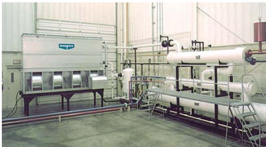
Cámara de Ensayos de Condensadores Evaporativos
