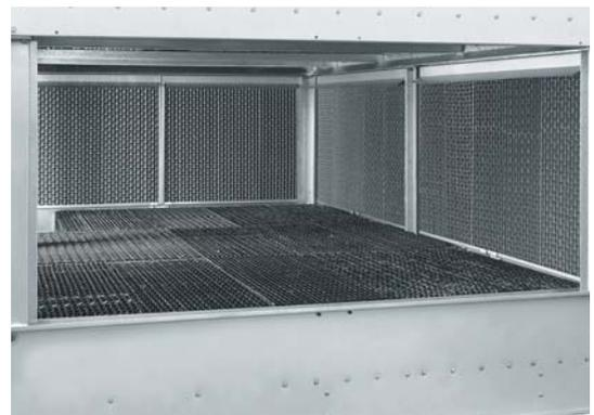
El silenciador de agua está construido en ligeras secciones de PVC, fácilmente desmontables para acceso a la balsa. El silenciador de agua no tiene ninguna influencia sobre el rendimiento térmico del equipo.
