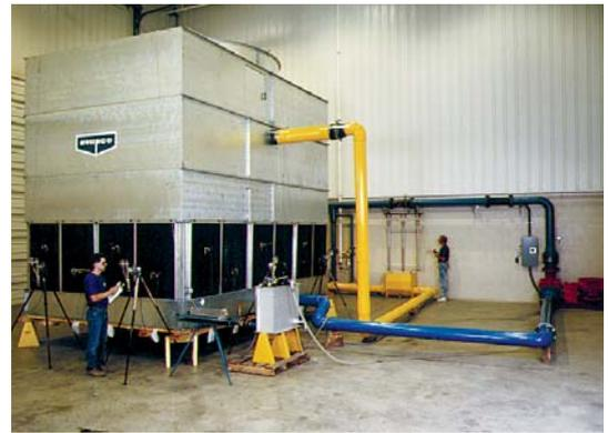
Cámara de Ensayos de Torres de Refrigeración
