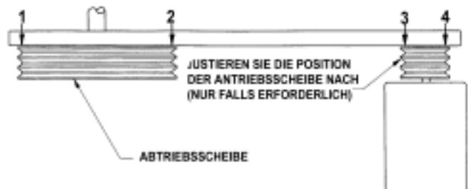
Abb. 30 – Ausrichtung der Keilriemenscheiben
