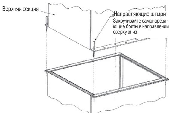
Рис. 12. Сборка секций агрегата
